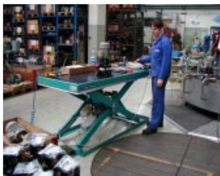
In der Arbeitszelle „Flanschposalux“ wird die Lastenbewegung mit einem speziellen Hebekran durchgeführt. Krafraubende Prozesse wie das Einpressen der Spaltringe, werden durch eine pneumatische Kleinpresse erledigt. Auch das Einrichten und Entnehmen der Flanschgehäuse für das Abdrücken, wird mit einem ausziehbaren Schublidentisch erleichtert.
