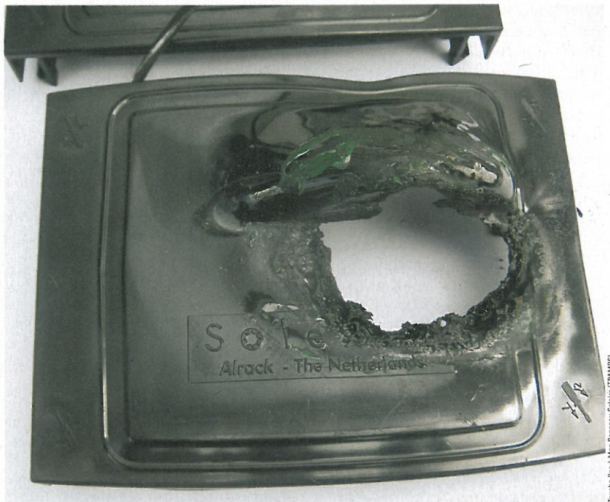
Im Extremfall schmilzt die durch den nicht abfließenden Strom entstehende Hitze das Gehäuse der Anschlussdose. Die Rückseitenfolie kann dann ebenfalls versengt werden.
